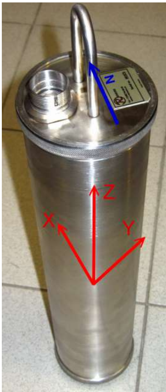
Рис. 3 Расположение осей чувствительности сейсмометра
