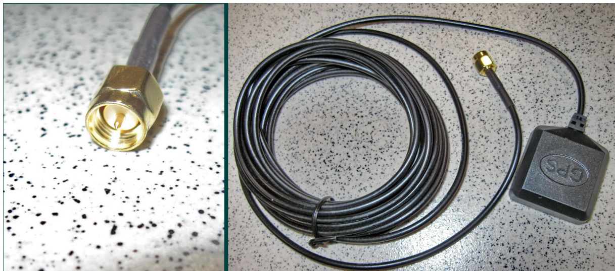
Рис. 8 Антенна GPS с 3 или 5 метровым кабелем, разъём, внешний вид.
