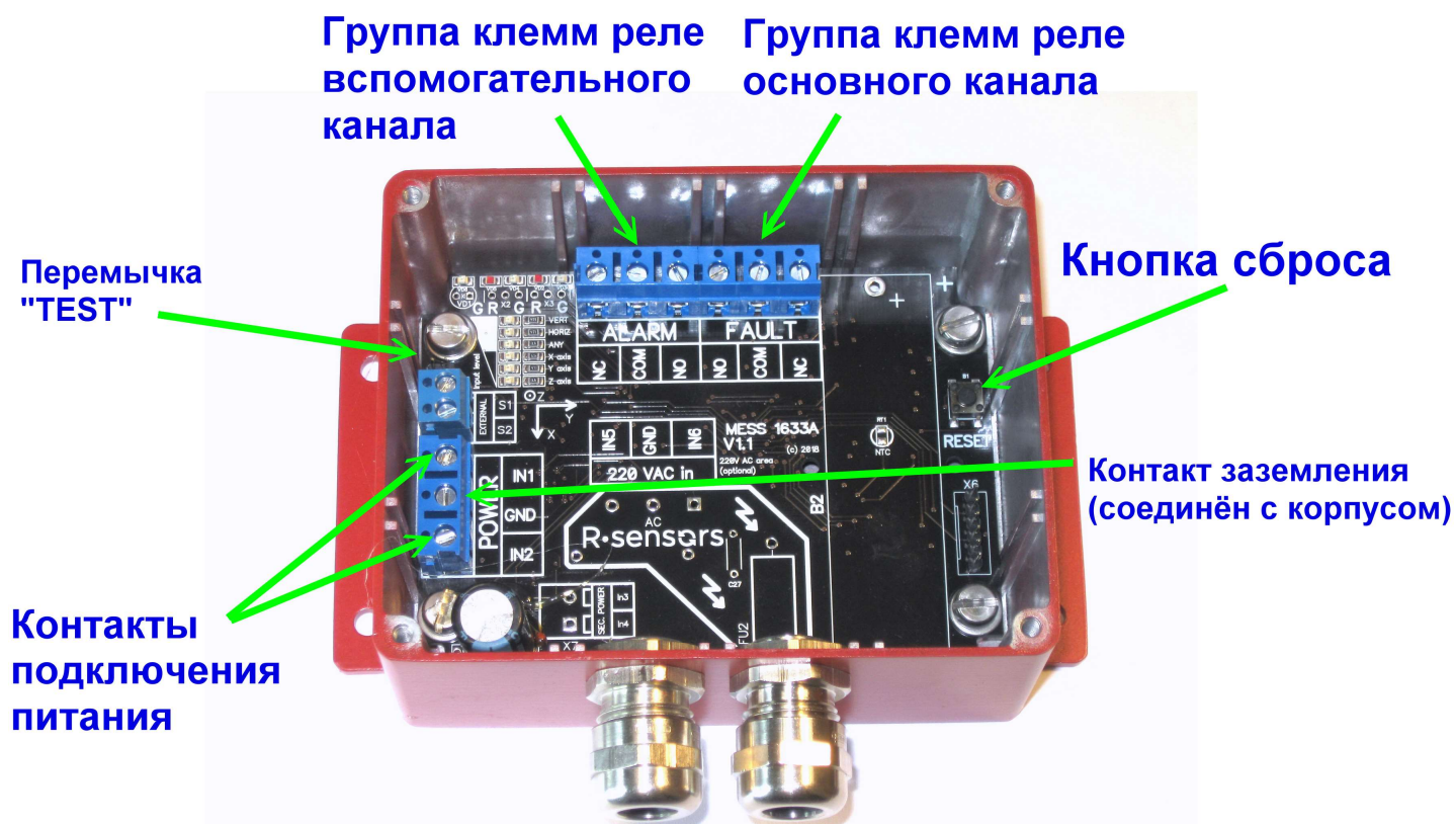
Рис 2. Внутреннее устройство акселерометра
