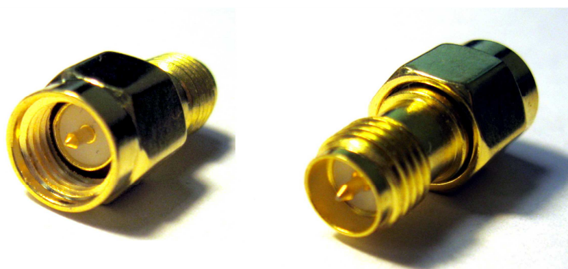
Fig. 9. SMA-M / RP SMA-M adapter
