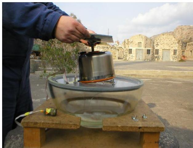
Рис 2. Установка сейсмометра СМЕ4211-OBS в глубоководную сферу.
