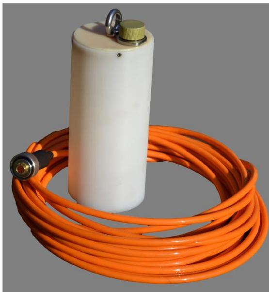
Скважинный трехкомпонентный сейсмометр СМЕ-4211-ВН15 выполнен в пластиковом водонепроницаемом корпусе, позволяющем производить его установку в неглубокие скважины и песчаные ямы глубиной до 15 метров. Прибор снабжен кабелем с герморазъемом, а также проушиной для спуска в скважину и последующего подъема.
