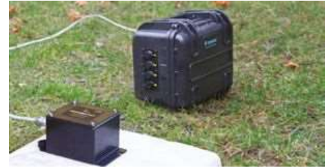
Акселерометры MTSS-1033A (Р-сенсорс) подключены к сейсмическому регистратору TESTBOX-2010 (TDG)
