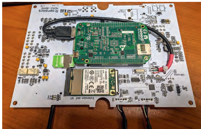
Рис. 3. Плата с установленными на ней одноплатным компьютером BeagleBone Green, 3G модемом Huawei и сим-картой оператора Мегафон
