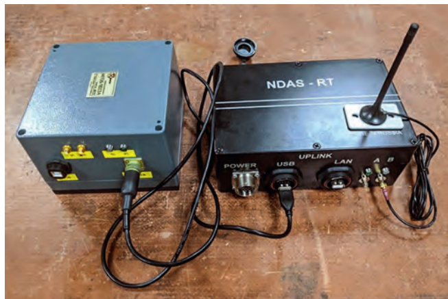
Рис. 4. Система в сборе: слева — цифровой акселерометр, справа — модуль реального времени с подключенной LTE-антенной
