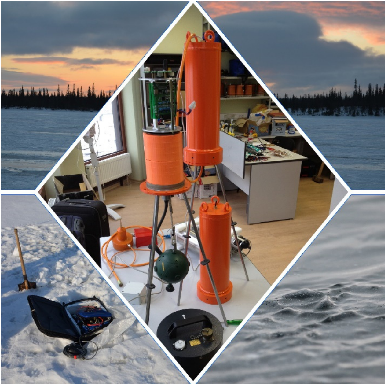
РИС. 3. Опытный образец информационно-измерительного комплекса ледового класса.
