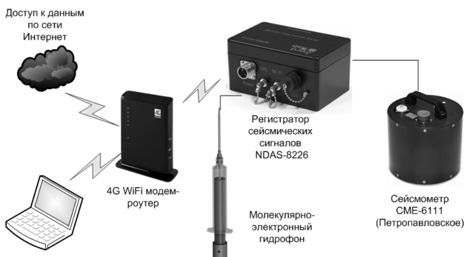
Рис. 1. Схема оборудования пунктов геофизических наблюдений на в селе Петропавловское и посёлке Южно-Курильск
