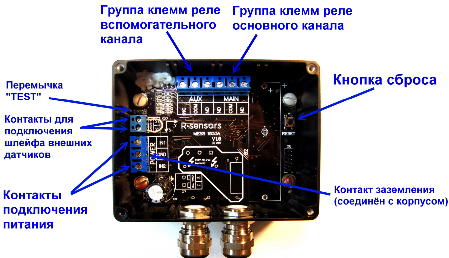
Рис 2. Внутреннее устройство акселерометра
