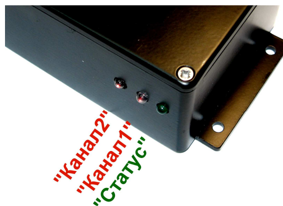
Рис 3б. Расположение индикаторов на корпусе акселерометра
