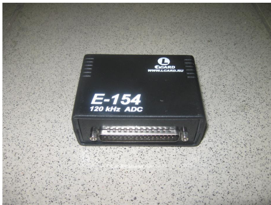
Рис. 4. Цифровой модуль (внешний модуль АЦП) E-154
