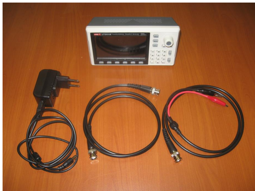
Рис. 2. Генератор синусоидальных сигналов UTG932E с комплектующими
